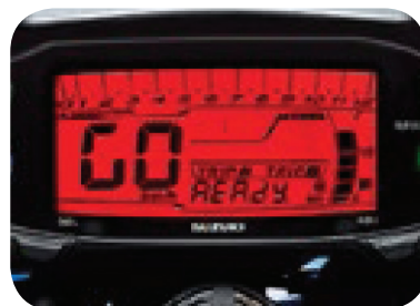
نشانگر هوشمند/ نمایشگر دنده و دور موتور
