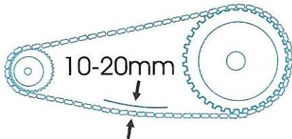
زنجر باید از 10 mm تا 20mm ( شکل 1 ) انعطاف داشته باشد . اگر جا بجا یی زنجیر بیشتر از 10 الی 20 میلیمتر باشد ، سریعاً " زنجیر می بایست تنظیم شود . رانندگی با موتور سیکلتی که زنجیر آن شل باشد خطرناک است . هر 5000 کیلومتر ، زنجیر می بایست تعویض شود .
