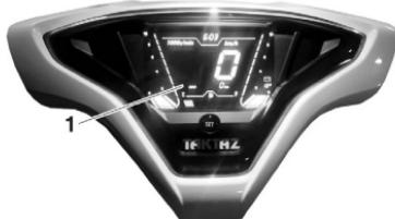
**نیشانگر ولتاژ باتری**
